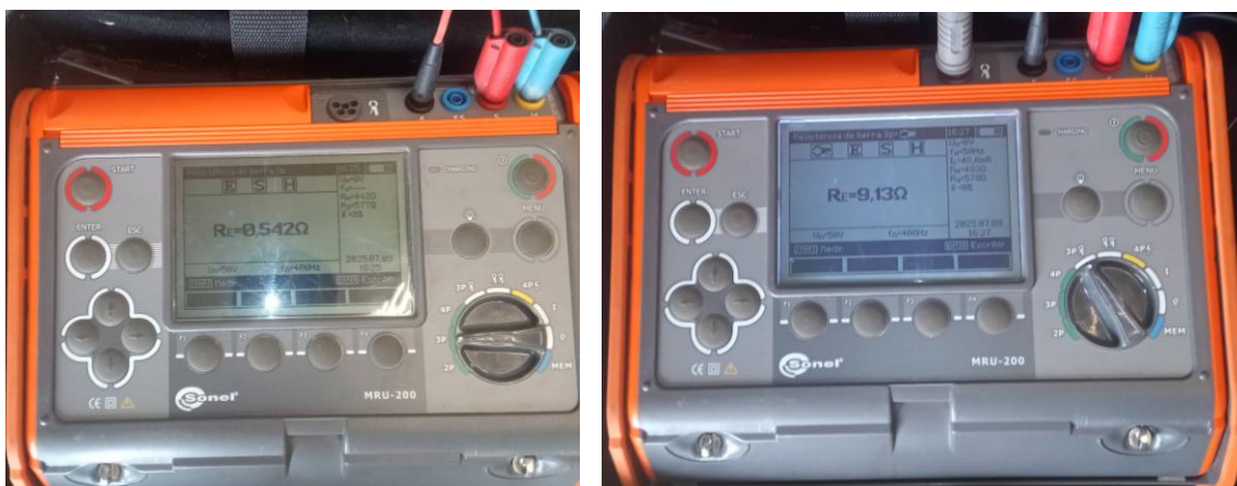
Figura 12 - Valores resistencia de puesta a tierra en servicio i independiente
