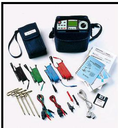
Figura 18 - Equipo utilizado en estudio resistividad
