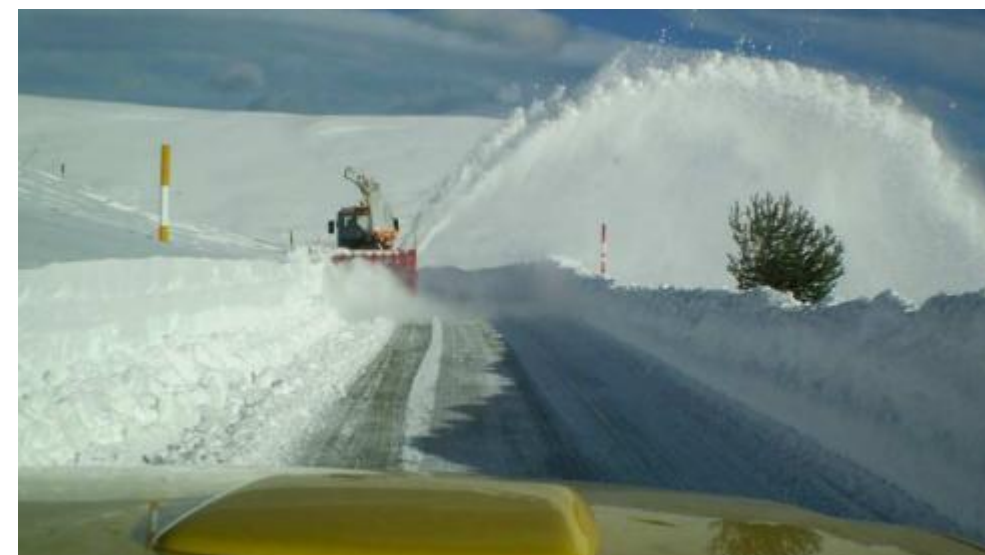
Figura 11. Màquina llevaneus treballant a la carretera BV-4031 amb la visualització de les balises de neu
