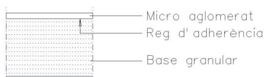
Paviment asfàltic microaglomerat. Ferm vorera
