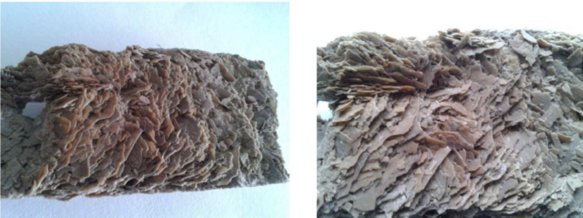
Figures 1 i 2 - Aspecte de la mostra analitzada, en forma de semi-canonada i detalls del cristall
