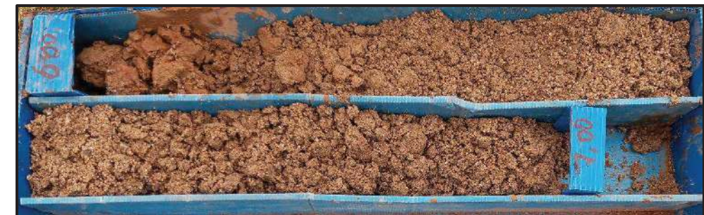
Aspecte dels materials sorrencs de la capa B, saturats i sense cohesió.
