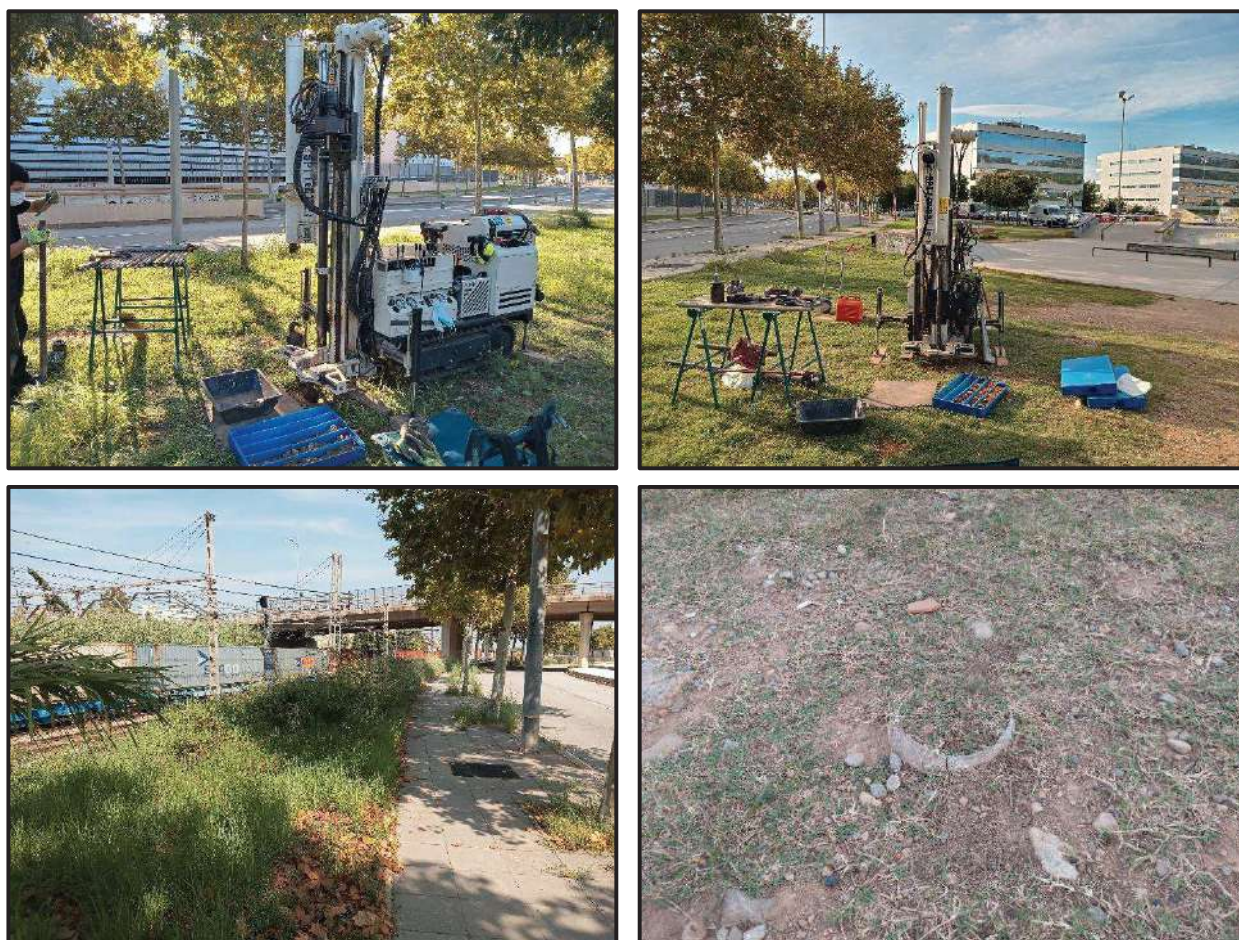
A dalt, diferents vistes de la zona d'estudi amb la maquinaria de sondeigs emplaçada, amb el sondeig S-1 a l'esquerra i el sondeig S-2 a la dreta. A baix a l'esquerra, detall de la franja de terra més estreta situada al nord de la zona d'estudi, on la presència de serveis dificulta l'emplaçament de nous sondeigs. A la dreta, detall de restes d'uralita en superfície.
