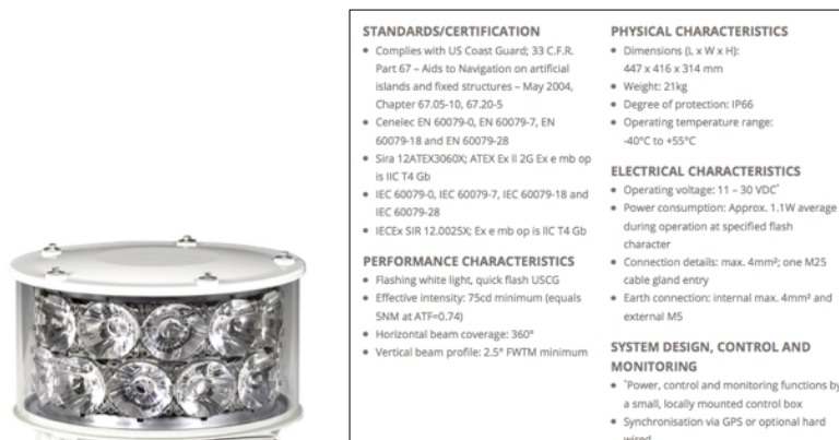
Imagen 6: Baliza amarilla/ámbar y características técnicas
