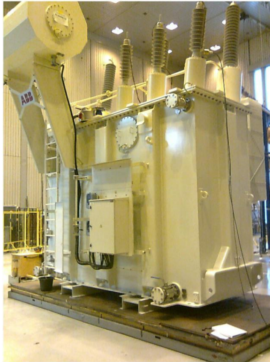
Figura 7. Vista de una reactancia similar a las que se tiene previsto instalar en la subestación eléctrica
