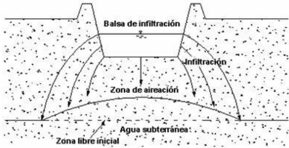
Figura 3: Esquema representatiu d'un assaig de Permeabilitat pel mètode de Haefeli
