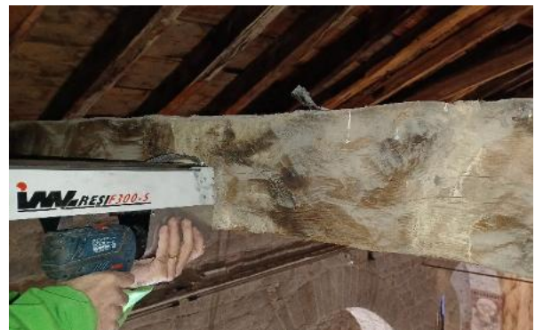
Figura 9. Tirant T8. Pèrdua de secció de 5 mm al centre per podridura bruna. Resistografia R3
