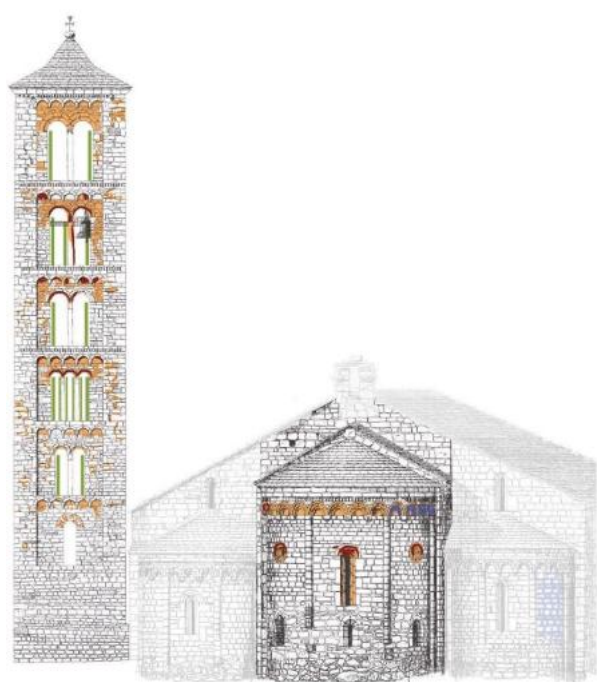
Capçalera i campanar durant la Fase II, amb indicació de la presència de restes pictòriques i d'acabats de junta de carreu (Elaborat a partir de Marqués 2016)
