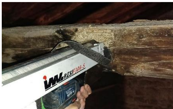
Figura 8. Tirant T9. Pèrdua de secció de 20 mm al centre per podridura bruna. Resistografia R2
