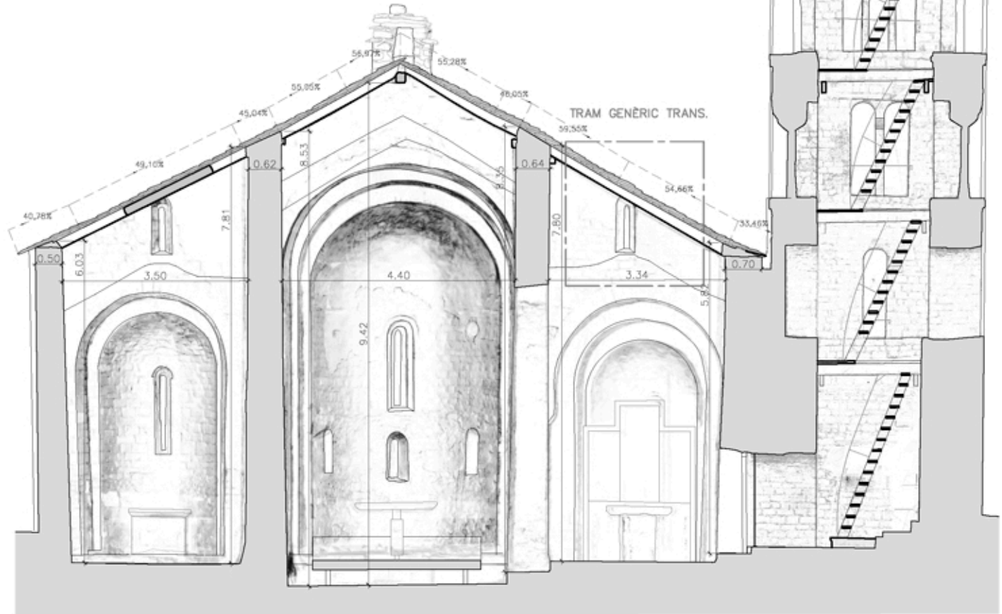
SECCIÓ TRANSVERSAL ESTAT ACTUAL NAU_B-B'
