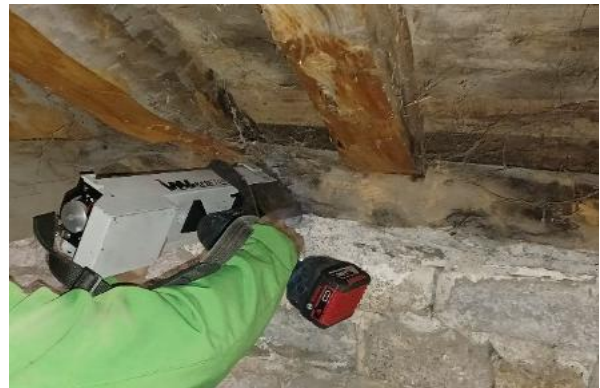
Figura 23. NC_N_CORS_N_3002. Realització de resistografia R1 al cap oest. (Veure detall a l'annex II)
