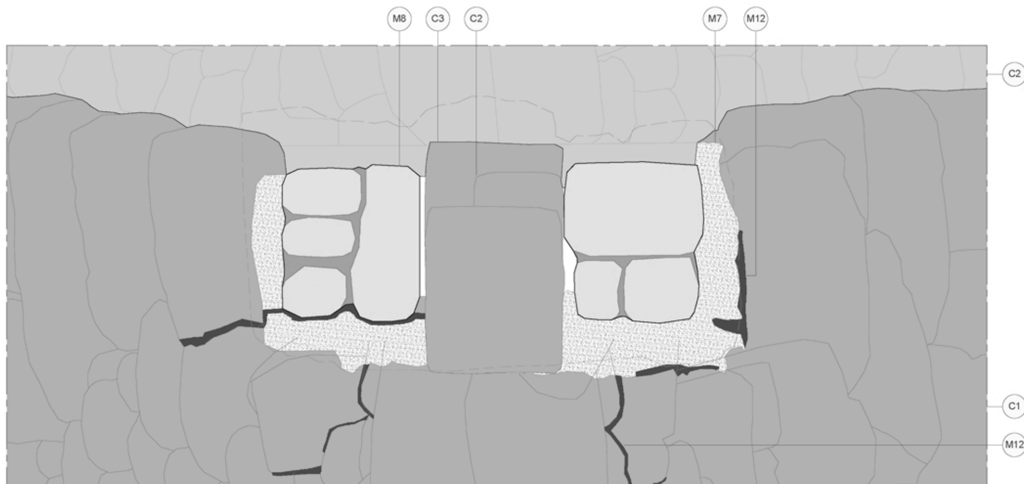
ESTAT ACTUAL_DETALL E_RESOLUCIÓ ESPADANYA_PLANTA
