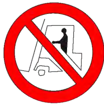
PROHIBIT EL PAS A CARRETÓ
