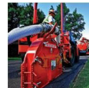
Figura 40. Equip de micro-rasa comercial.
