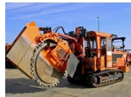
Figura 39. Rasadora de disc de tall.
