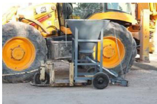
Figura 53. Cuba especial per a abocament de morter.
