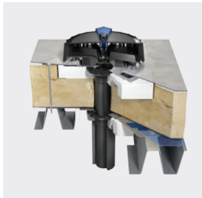
EJEMPLO 2: CUBIERTA LIGERA, AISLADA CON LÁMINA PARA CUBIERTA Y CONEXIÓN A BARRERA DE VAPOR GEBERIT La carga estática de Geberit Pluvia sobre las cubiertas ligeras es muy baja. La instalación se realiza con una unión por brida, lo que permite que el largo tubo de conexión supere sin esfuerzo grandes grosores de aislamiento. La conexión a barrera de vapor Geberit puede utilizarse tanto para lámina como para betún.
