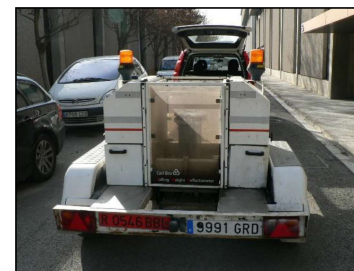
Sistema eléctrico de elevación de las masas situadas en el remolque
