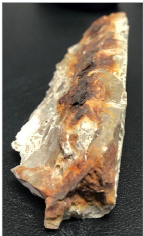
Fig. 9. Vista despreniment de peces de formigó al fons del dipòsit i detall peça formigó despresa.
