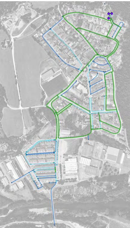
Imatge 61. Distribució de velocitats a la xarxa amb les inversions del Pla Director considerant el funcionament d'un hidrant (en m/s). Bonnatí
