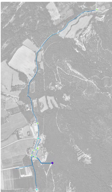
Imatge 53. Distribució de velocitats amb la xarxa actual i la demanda de l'any horitzó (en m/s). Bonmatí
