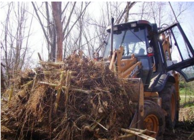
Figura 32 Procés mecànic d'eliminació de canya.
