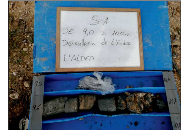
Caixa de testimonis del sondeig S-1 entre 9,0 i 10,0 m.
