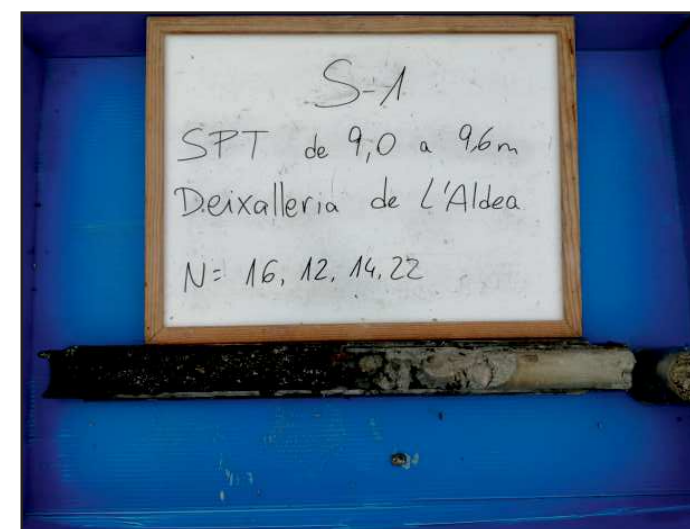
Assaig SPT realitzat entre 9,0 i 9,6 m.
