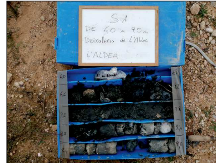
Caixa de testimonis del sondeig S-1 entre 6,0 i 9,0 m.
