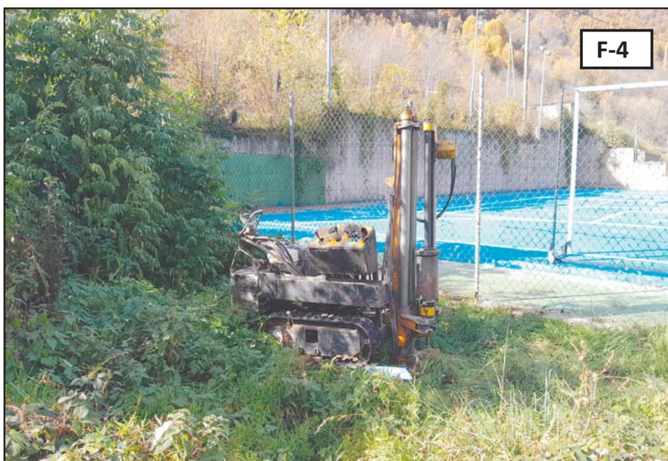
Fotografies 3 i 4: Vista de la parcel·la en estudi, i detall de l'emplaçament de la màquina realitzant l'assaig de penetració dinàmica DPSH P-3 i P-4, respectivament.
