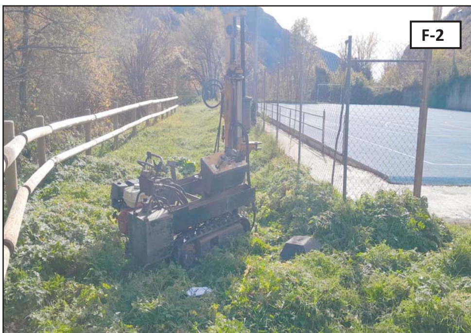
Fotografies 1 i 2: Vista de la parcel·la en estudi, i detall de l'emplaçament de la màquina realitzant l'assaig de penetració dinàmica DPSH P-1 i P-2, respectivament.
