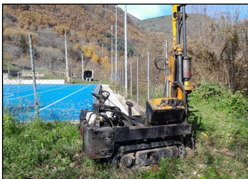
Fotografia 1. Detall de la màquina per realitzar els assaigs de penetració dinàmica DPSH.
