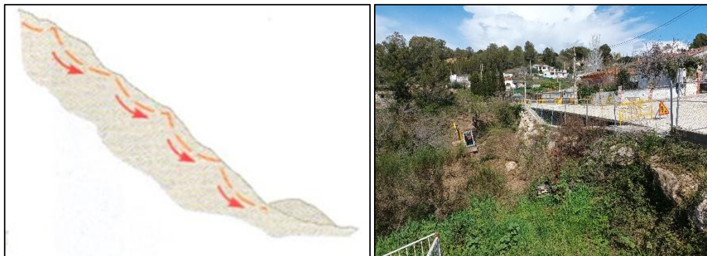
Imatge 6-6. A l’esquerra el model estimat de moviment cinemàtic tipus successiu. A la dreta vista de la inestabilitat.
