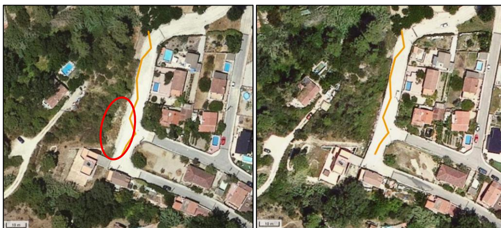
Imatge 6-3. Ortofotomapa del 2021 a l'esquerra a on s'observa la major amplada de l'escullera un cop refet el carrer i fins al 2024 a la dreta a on no s'observen patologies.
