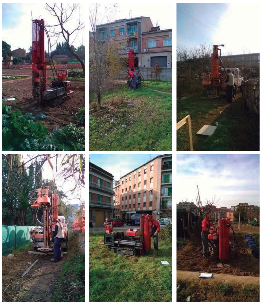
Vistes dels sis sondeigs realitzats al solar objecte d'estudi, P-1, P-2, P-5 i P-6 del tipus DPSH i S-3 i S-4 del tipus Rotació helicoidal
