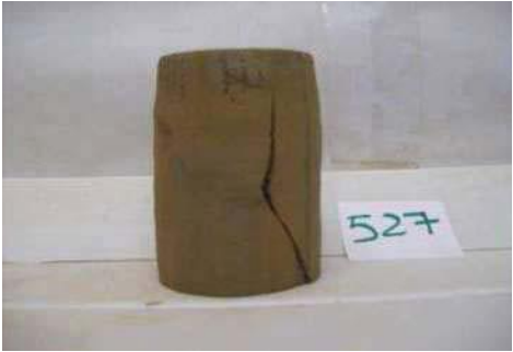
Forma de rotura
