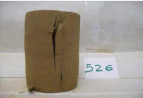
Forma de rotura
