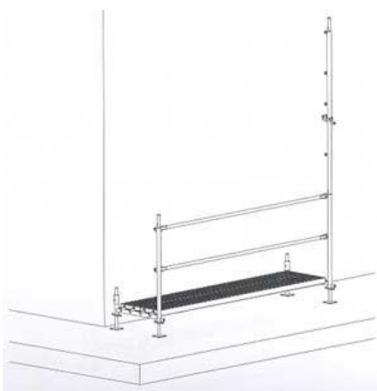
Figura 6 Instal·lació del marc parcial a L
