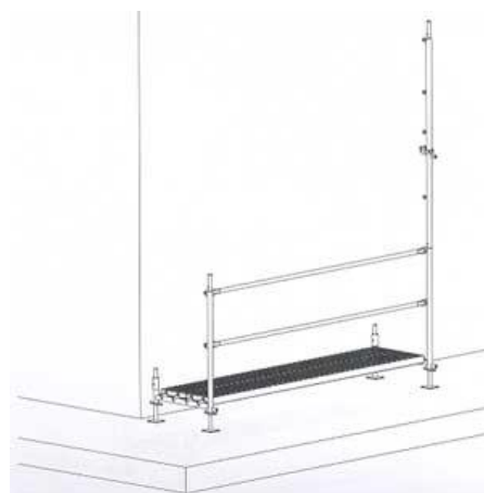
Figura 5 Inserció del marc parcial en R en l'element d'arrencada
