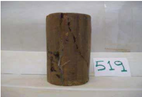
Forma de rotura
