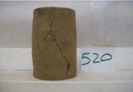
Forma de rotura
