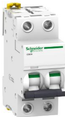
Magnetotèrmic 16A, tipus PIA corba B, 2P, 6000A Schneider terciari A9F78216 o equivalent
