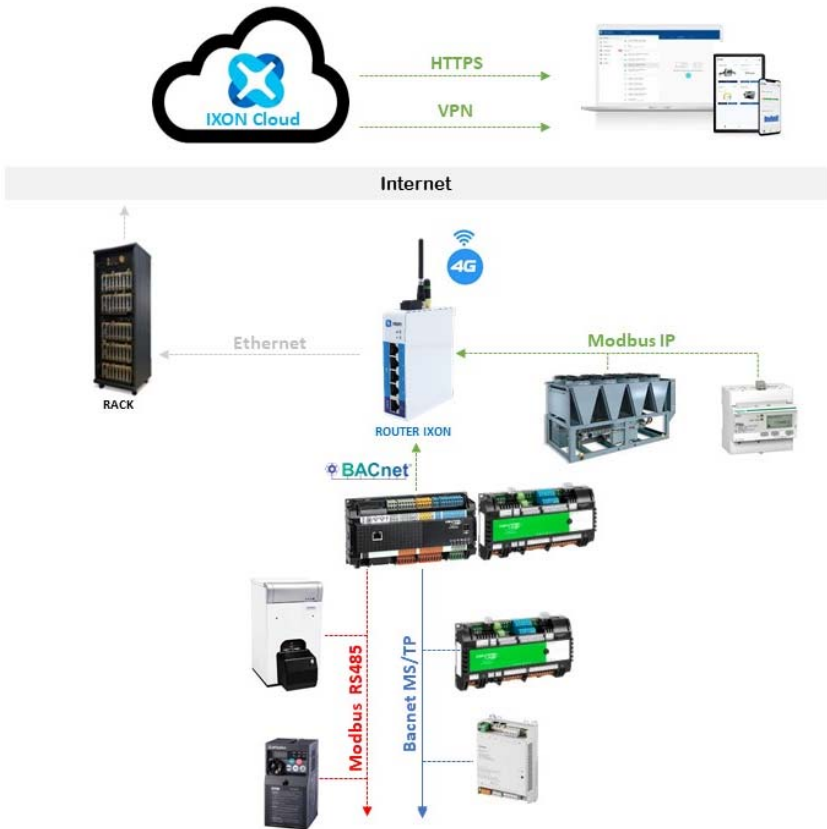
Imatge 7. Estructura Telecomandament Tipus Servidor
