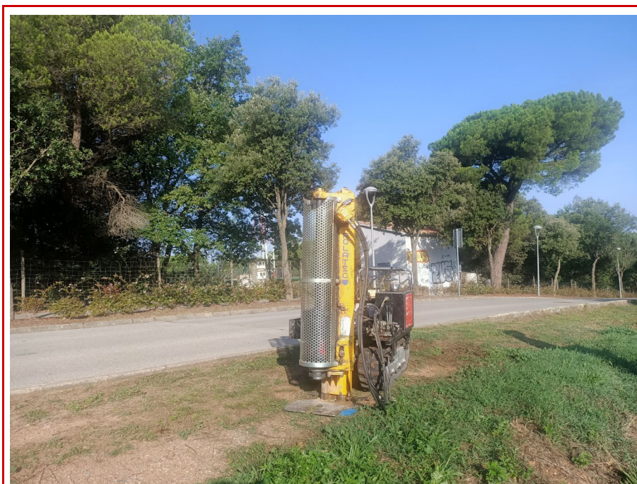
Fotografia 2 – Equip d'assaig penetromètric en el punt d'assaig P-2
