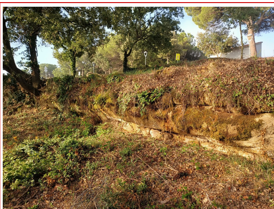
Fotografia 3 – Aflorament del substrat resistent el talús de les rodalies de la zona a edificar
