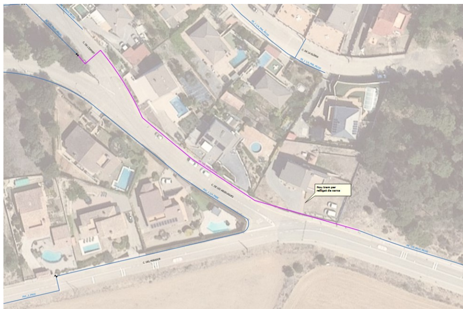
Imatge 15. Relligat de xarxa DN 125 mm (carrer Argelagues)
