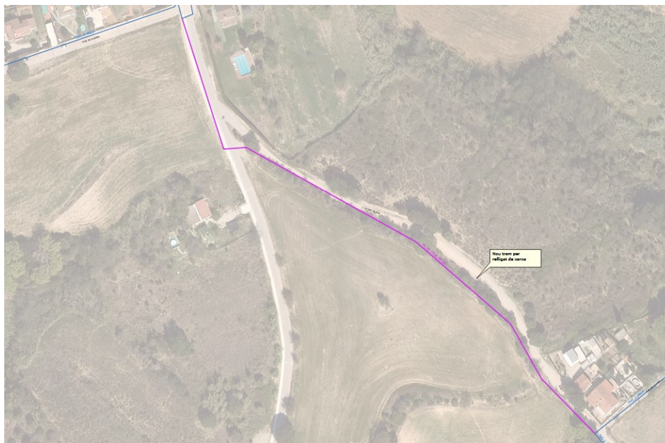
Imatge 16. Relligat de xarxa DN 90 mm (camí de Sant Valerià)
