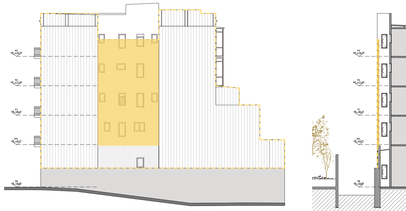
ETAPA 3: ENDERROC I DESMUNTATGE DELS ENVANS PLUVIALS, MURS I REVESTIMENTS.
