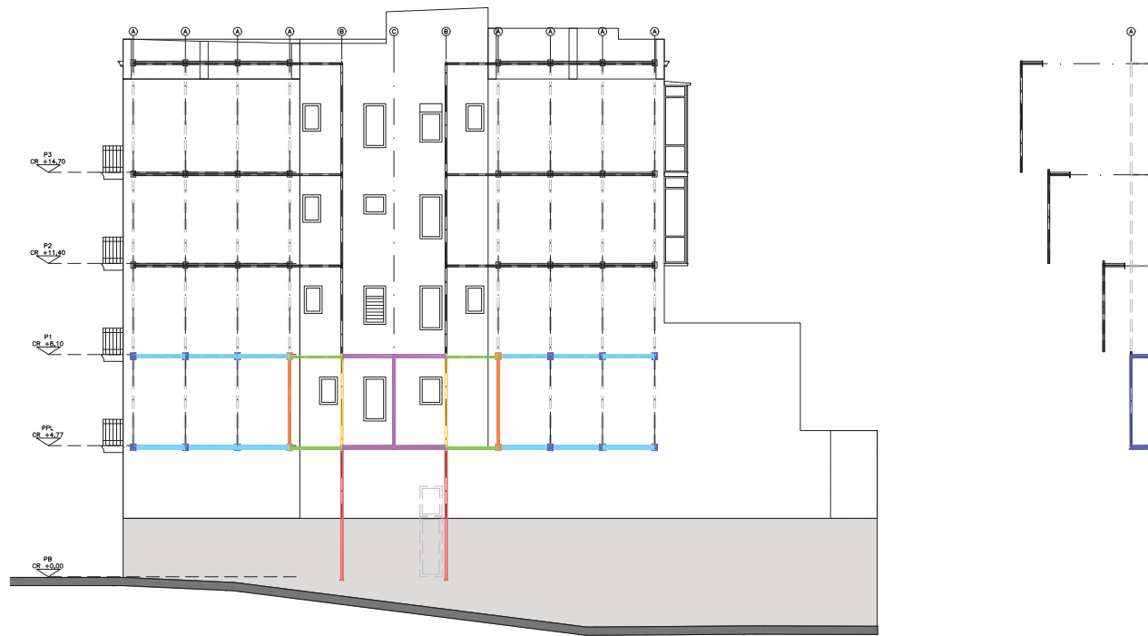
ETAPA 11: REPETICIÓ DEL MUNTATGE DEL PÒRTIC O COSTELLA (A) I TRAVESSERS FINS ELS EXTREMS TRAM INFERIOR
