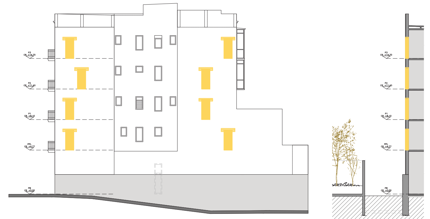
ETAPA 4: ENDERROC I FORMACIÓ DE LLINDES DE LES NOVES OBERTURES (BALCONERES)
