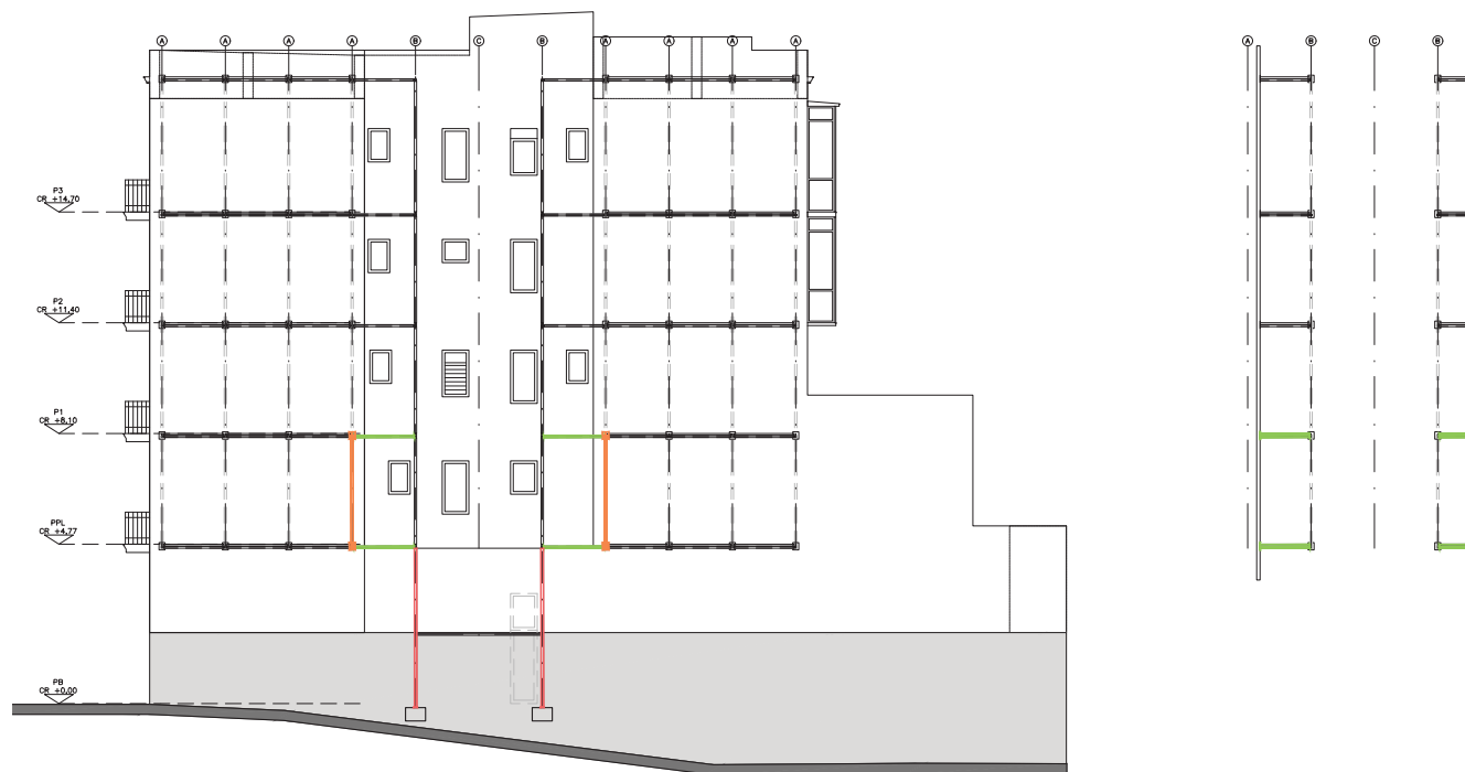
ETAPA 7: MUNTATGE DELS TRAVESSERS DEL PÒRTIC TIPUS (A) QUE MÉS ENDEVANT CONNECTARÀ AMB EL PÒRTIC TIPUS (B) A CADA COSTAT DEL PATI
