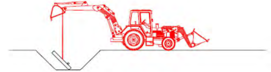
3. Col·locació de la base del pou
