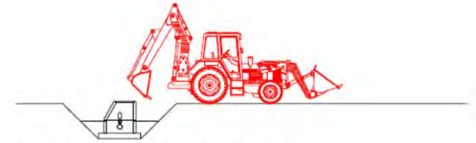
6. Reblert del pou amb retro-excavadora en tongades
