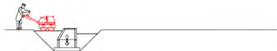
7. Compactació de terres al voltant del pou
