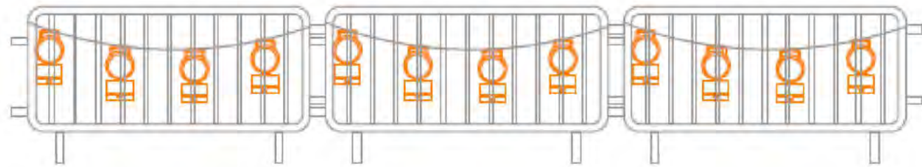
TANCA D'OBRA AMB BALISES PENJADES AMB CÈL·LULES FOTOELÈCTRIQUES
