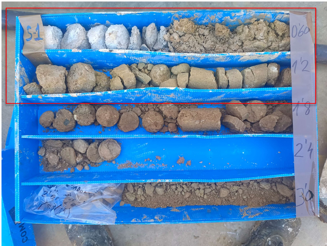
Foto 1. Caja de sondeos S1 de 0,00 a 3,00 m.
