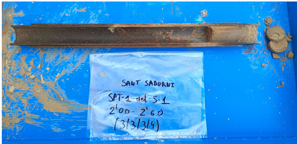
FOTO 5. ENSAYO SPT-1 SONDEO S1.
