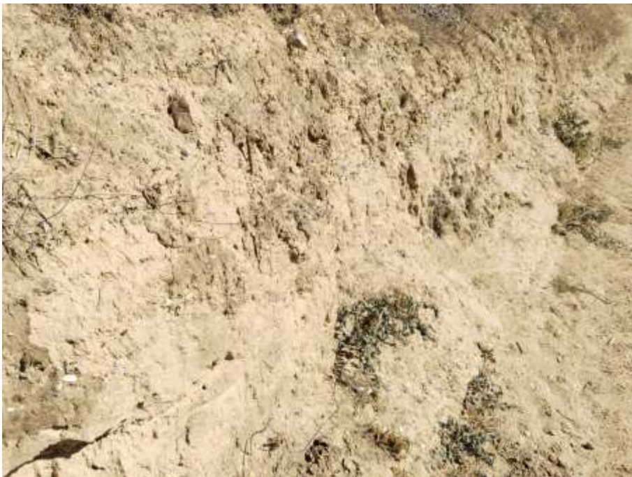
Detall aflorament a la zona oest del solar. Llims sorrencs i gravetes disperses
