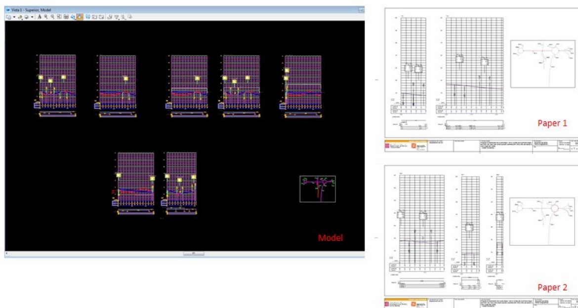
Figura 4. Exemple de plànol de perfils longitudinals format per diversos fulls de paper
