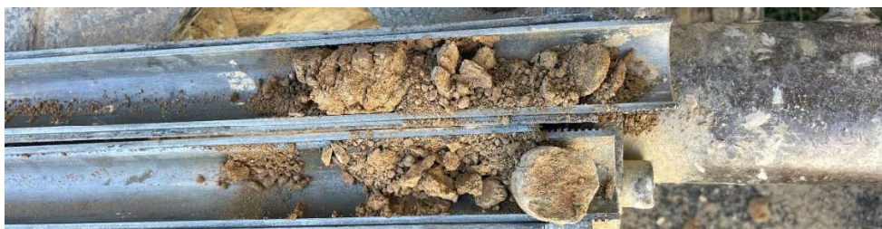
Fotografies 2, 3 i 4. Sondeig S-2. Assaigs SPT recuperats a -1m i -2,5m
