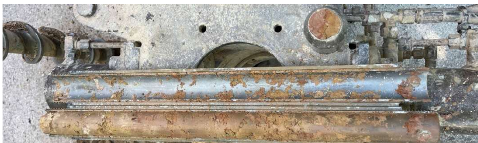
Fotografies 5, 6 i 7. Situació del sondeig S-3 i mostres tipus SPT a -1m i -3m.
