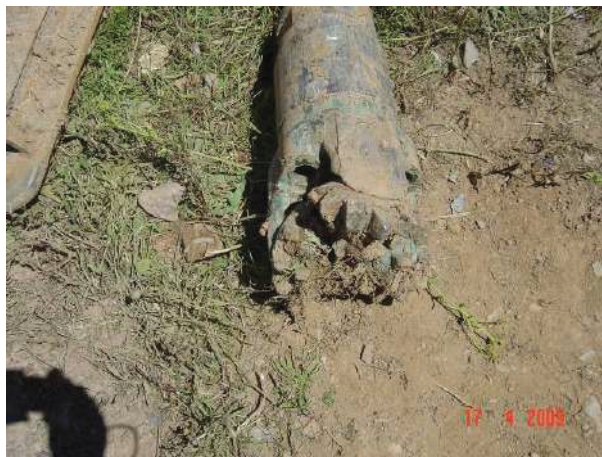
Fotografía nº 1. Detalle de uno de los Triconos
