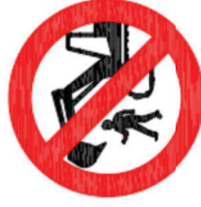
prohibido permanecer en el radio de acción de la maquinaria
