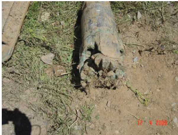
Fotografía nº 1. Detalle de uno de los Triconos
