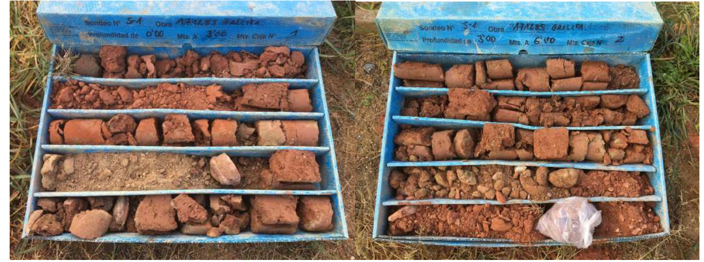
Foto 5.- caixes testimoni de l'assaig S-1 de 0.00 a 3.00 metres.
