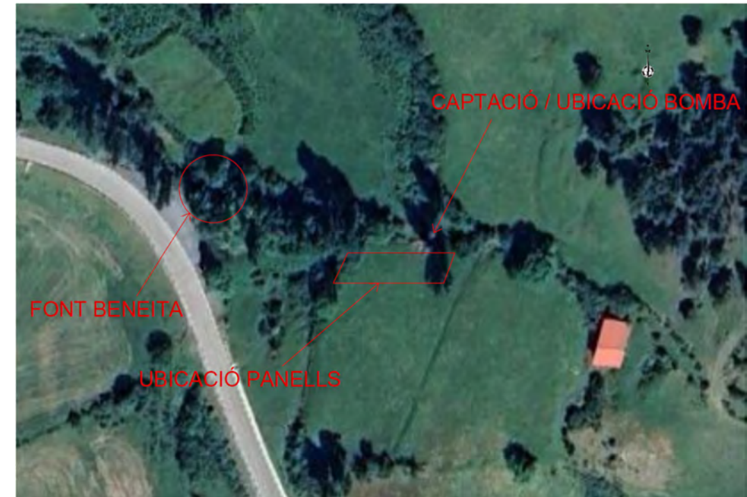
Fig5. Ubicació sistema solar de bombeig
