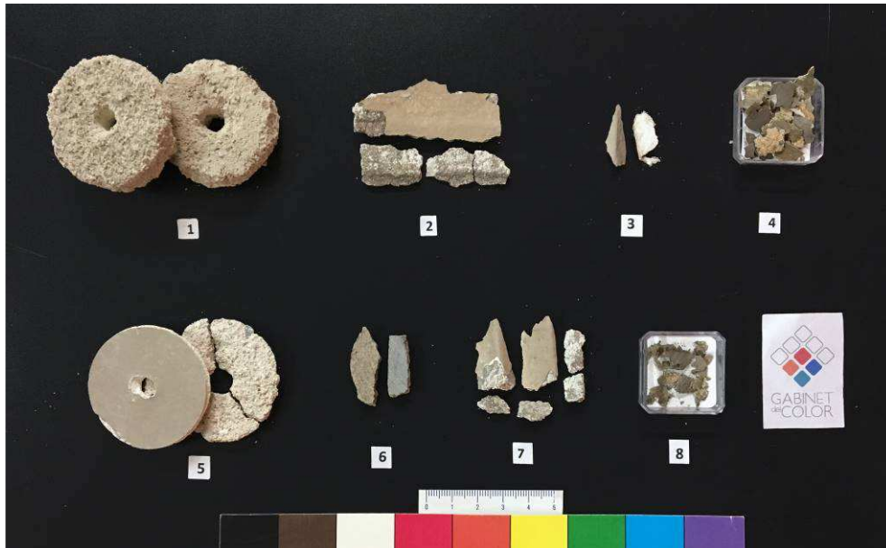
Selecció de les mostres extretes en diferents punts i elements de la façana.
