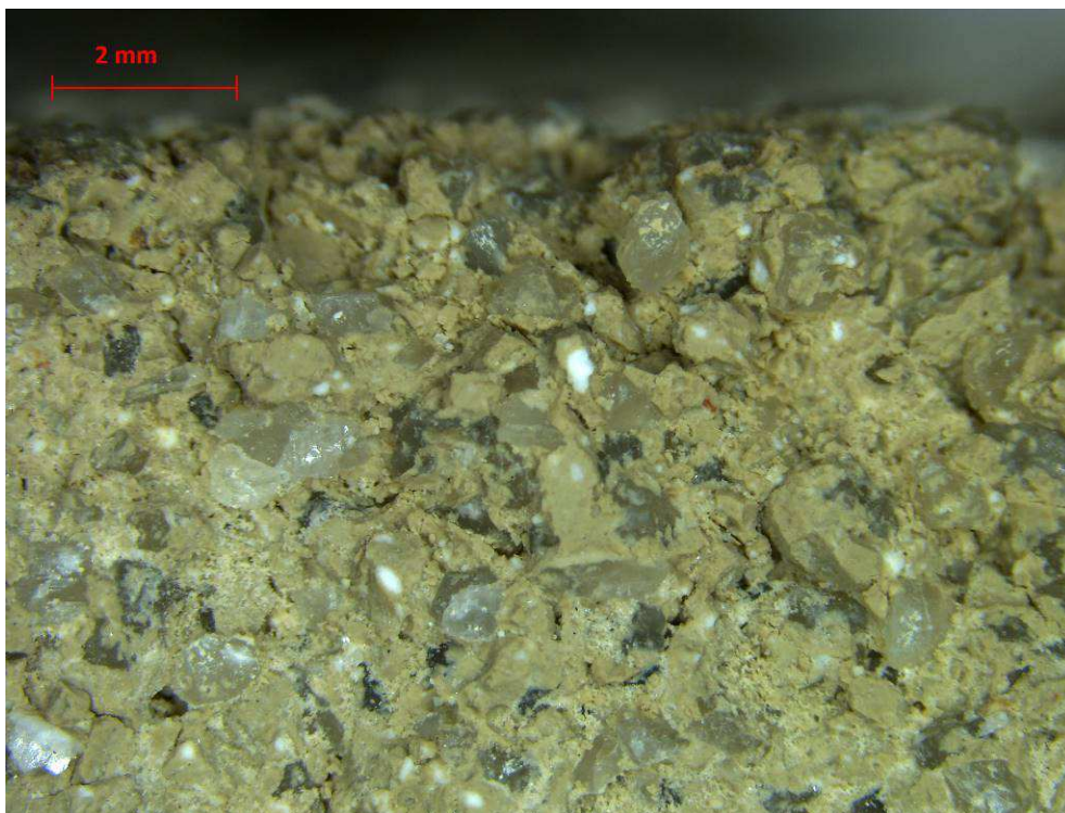
Micrografia a 10X de la mostra nº1: parament. Estuc preconfecionat de calç i marbre, tenyit en massa acabat raspat i del Color A.
