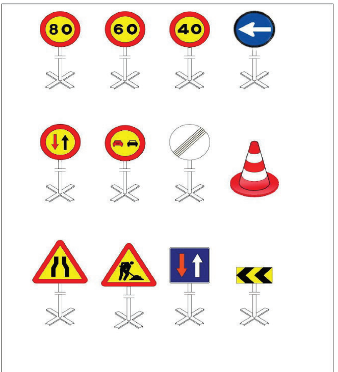
Equip estàndard Senyalització provisional d'obres per carretera convencional Equip de senyalització provisional
