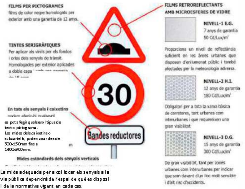
Figura 127. Característiques tipus senyals verticals part frontal.
