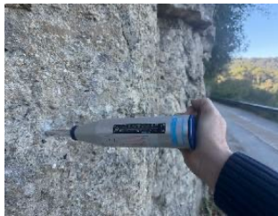
Fot 6. Assaig de resistència de la roca matriu mitjançant escleròmetre schmidt
