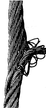
Cliché 10 - Rotura o extrusión del alma de acero generalizada como consecuencia de una corrosión por un agua salada. El cable debe ser retirado inmediatamente.
