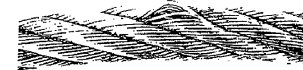
Cliché 11 - Un solo cordón se fortalece por la extrusión de los hilos. Aunque el examen de una mayor longitud del cable muestra que el defecto se repite regularmente sobre el mismo cordón a distancias de un paso.
