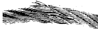
Cliché 6 - Roturas de alambres a la altura de la polea de compensación y asociadas con un desgaste profundo sobre una cierta longitud ocasionado por el roce de la boquilla. El cable debe ser retirado.
