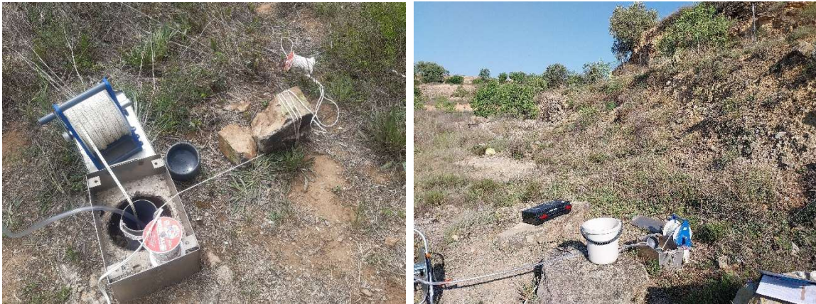
Il·lustració 7. Assaigs de bombament en els piezòmetres de l'abocador.
