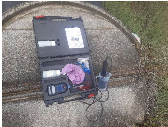
Il·lustració 8. Registre dels paràmetres fisicoquímics de l'aigua mitjançant una sonda multiparamètrica i material de mostreig.
