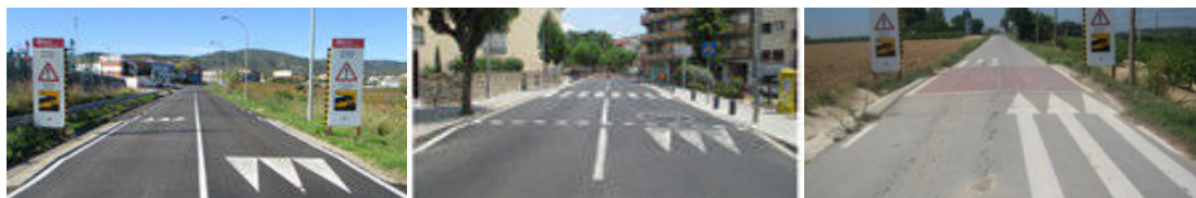
Plataforma reductora de velocitat en secció
