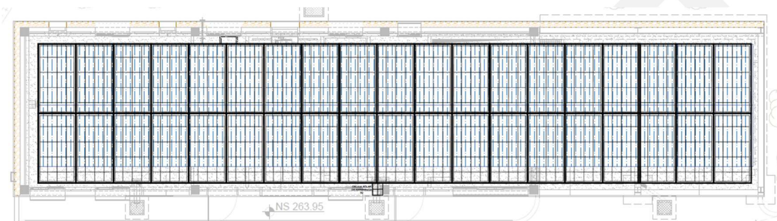
Imatge 3. La disposició de les plaques en projecte no permeten realitzar un manteniment correcte.
