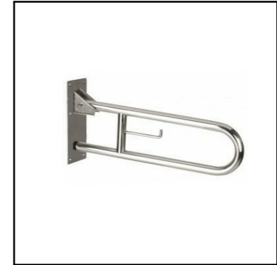
EB10: Barra abatible amb portarrotlles Barra abatible ø30-40mm per fixar a paret de gir vertical amb portarrotlles. Acabat acer inoxidable satinat. Soportarà una força de 1kN. Inclou kit anticonductiu. Model BG0800C de MEDICLINICS o equivalent. Unitats: 2
