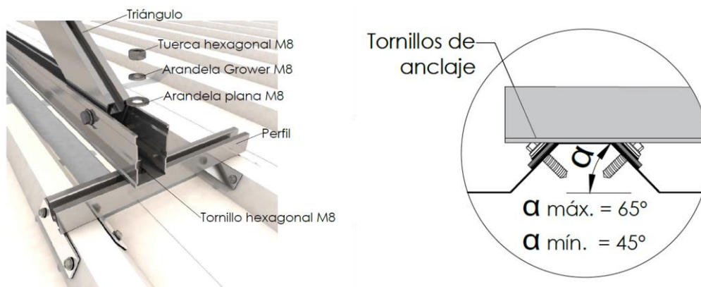
Figura 11. Detall fixació mòduls
