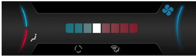
Figura 5. Barra indicadora de potència de la climatització de la zona de conductor.
