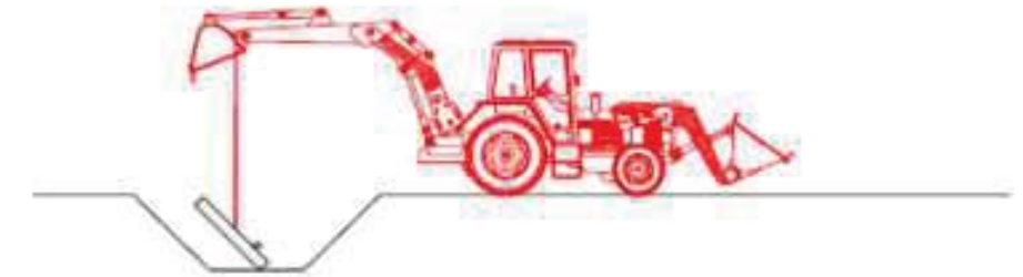
3. Col·locació de la base del pou
