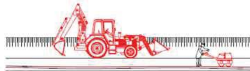
8. Rebuït amb retro-excavadora de la rasa en tongades
