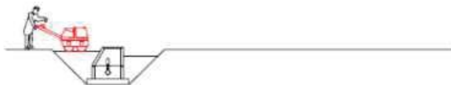
7. Compactació de terres al voltant del pou
