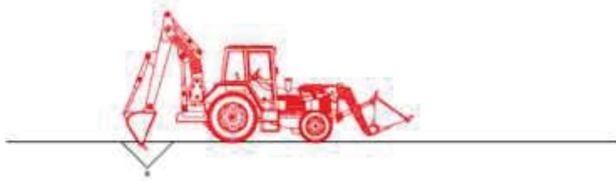
1. Buidat de terres amb retro-excavadora
