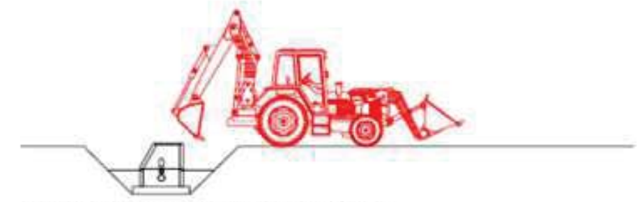
6. Reblert del pou amb retro-excavadora en tongades
