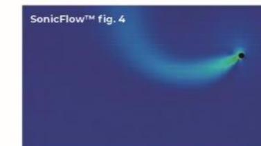
Ejemplo: patrón de aire en calefacción, ΔT de 120 Pa (≈0,5 iwg) de presión estática en un medio +6 K y teórico con un espacio grande.
