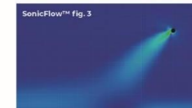
Patrón de aire en espacio teórico: impacto de la refrigeración a ΔT de -6 K y presión estática de 120 Pa (≈0,5 iwg).
