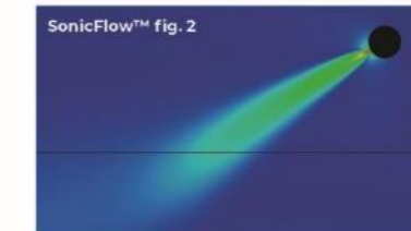
Ejemplo de aplicación habitual: refrigeración a 3 m (≈10 ft), ΔT de -4 K y presión estática de 120 Pa (≈0,5 iwg). El aire entra en la zona ocupada con la dirección y la velocidad necesarias. La línea negra indica la zona ocupada a 1,8 m (≈6 ft) sobre el nivel del suelo.
