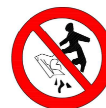
PROHIBIT TREPITJAR SÒL NO SEGUR
