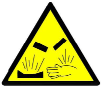
RISC DE CORROSIÓ
