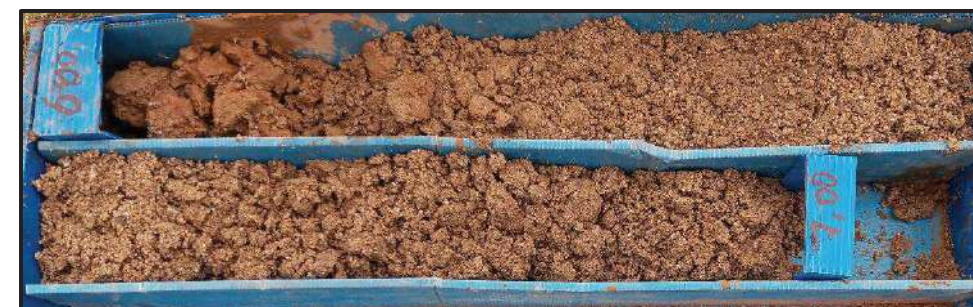
Aspecte dels materials sorrencs de la capa B, saturats i sense cohesió.
