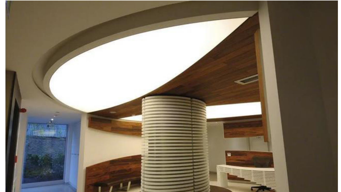
Exemple de sostre lluminós amb tela retro-il·luminada "Barrisol".
